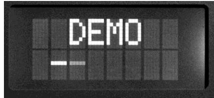
После нажатия клавиши **ВВОД** прибор запускает режим сигнала тревоги примерно на 5 с, после чего автоматически переходит к экрану режима контроля/измерения, в котором был перед входом в **МЕНЮ** с целью демонстрации функции **ДЕМО**.
