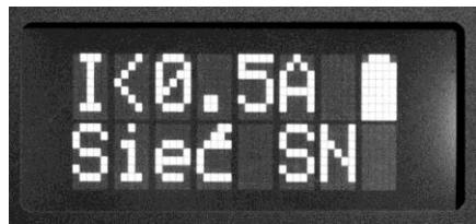
После нажатия клавиши **ВВОД** прибор автоматически переходит к экрану режима контроля/измерения. Сигнализатор находится в том рабочем режиме, в котором был перед входом в **МЕНЮ** для изменения частоты.
