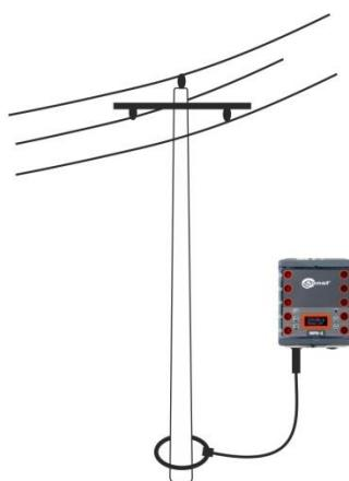
Рис.6. Работа прибора с использованием одних токовых клещей
