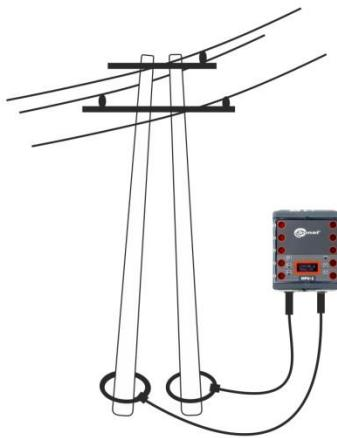
Рис.7. Работа прибора с использованием двух токовых клещей
