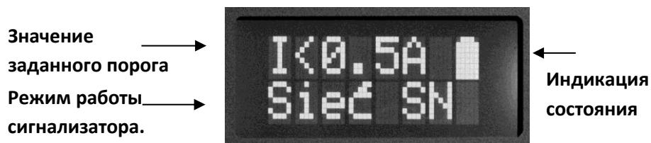
Рис.3. Вид экрана при измерении в режиме Сеть SN.
