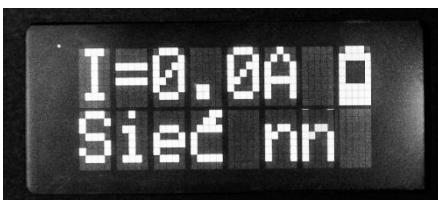
После нажатия клавиши **ВВОД** прибор автоматически переходит к экрану режима *Сеть nn*. Сигнализатор, находящийся в режиме работы *Сеть nn*, в реальном времени отображает на дисплее измеряемое значение проходящего через клещи тока. Прибор контролирует/измеряет переменный ток частотой 50 Гц или 60 Гц в зависимости от настроек пользователя
