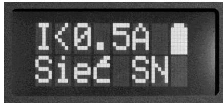
После нажатия клавиши **ВВОД** прибор автоматически переходит к экрану режима *Сеть SN* и начинает мониторинг тока, протекающего через клещи. Верхняя строка дисплея показывает, что для тока большего, чем указанное там значение, будет включен сигнал тревоги.
