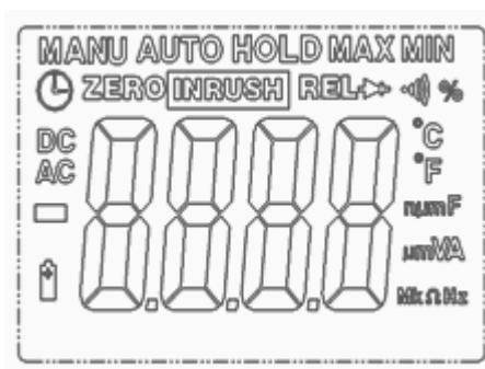
**HOLD** - Функция фиксирования результатов на экране включена.
