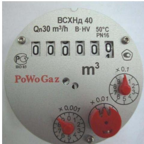
На рисунке показан счётный механизм счётчика воды BCXНd-40 (прибор показан без магнитного экрана). Показания роликового индикатора составляют 000000, первого стрелочного указателя – 0 ( $0 \times 0,1$ )  $\text{m}^3$ , второго стрелочного указателя – 0 ( $0 \times 0,01$ )  $\text{m}^3$ , третьего стрелочного указателя – 8.5 ( $8.5 \times 0,001$ )  $\text{m}^3$ . Измеренный объём равен **0,0085  $\text{m}^3$**  или **8,5 л**.
