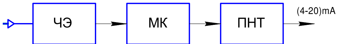
Рис.1 Структурная схема датчика.
