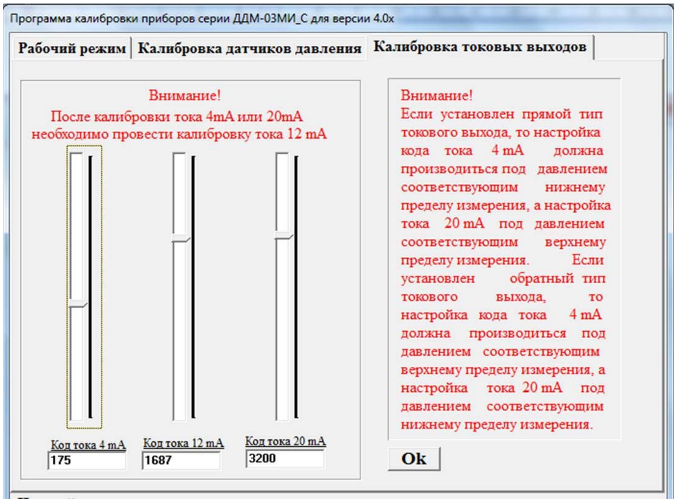
Рис. 4. Вкладка «Калибровка токовых выходов».
