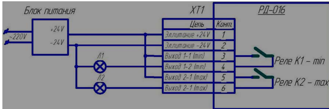
Рис. 4. Схема проверки работоспособности РД-016.
