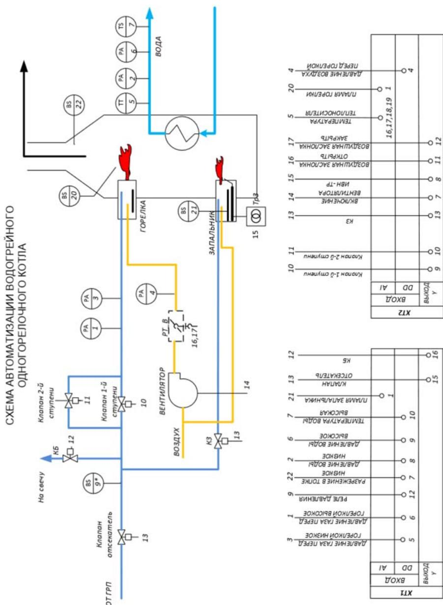
Рис. 10: Схема автоматизации водогрейного одногорелочного котла.
