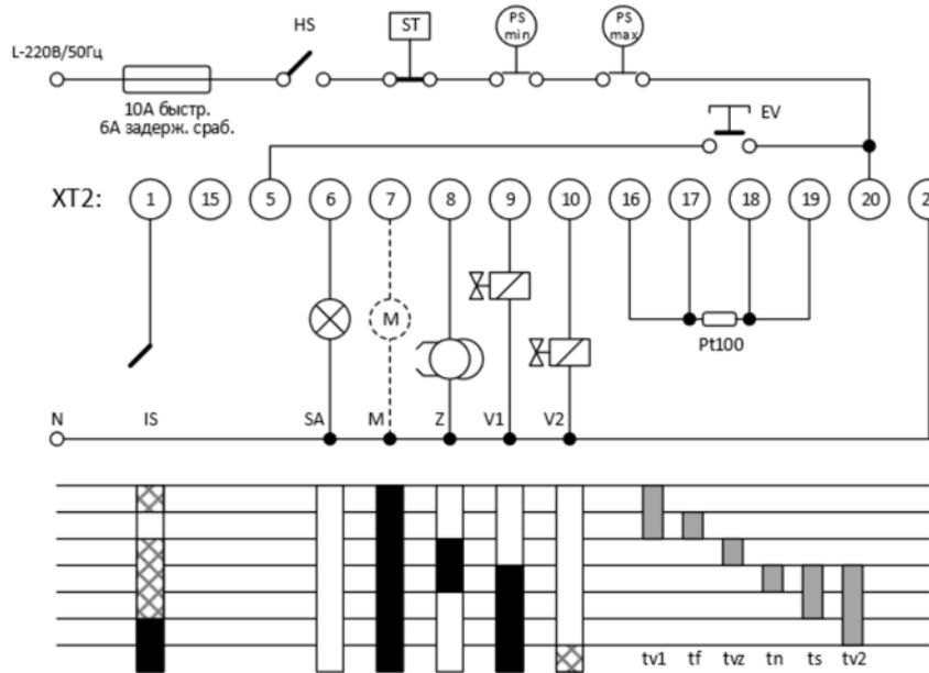
Рис. 12: Схема подключения и диаграмма работы автомата горения для атмосферной двухступенчатой горелки.
