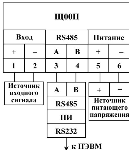
Рисунок Б.1 – Схема подключения приборов
