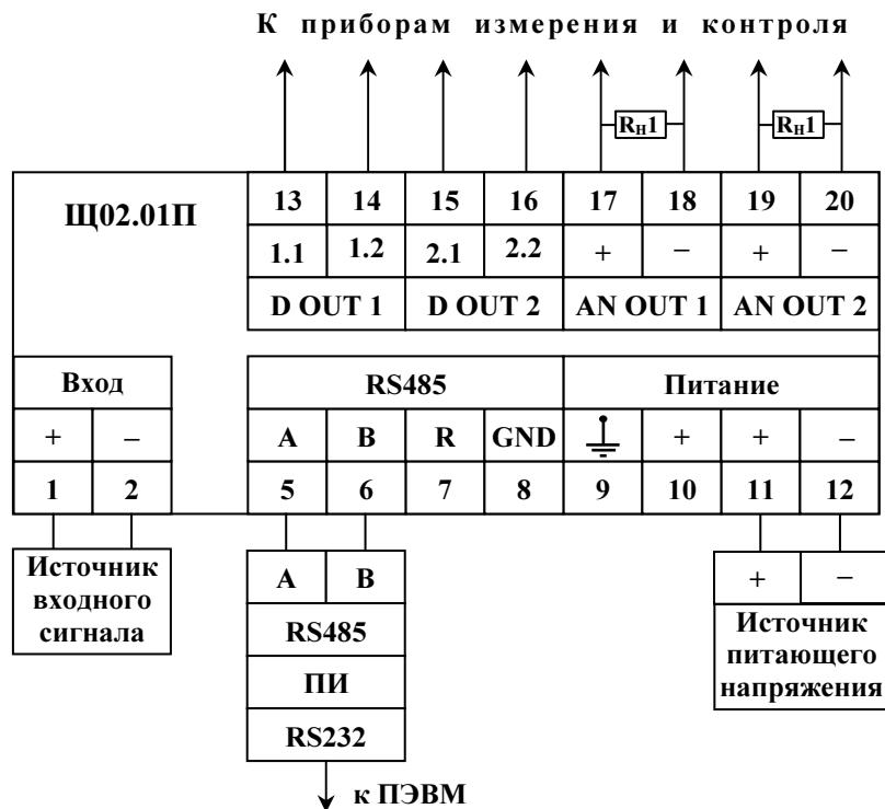
Рисунок Б.3 – Схема подключения приборов
