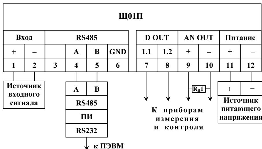
Рисунок Б.2 – Схема подключения приборов
